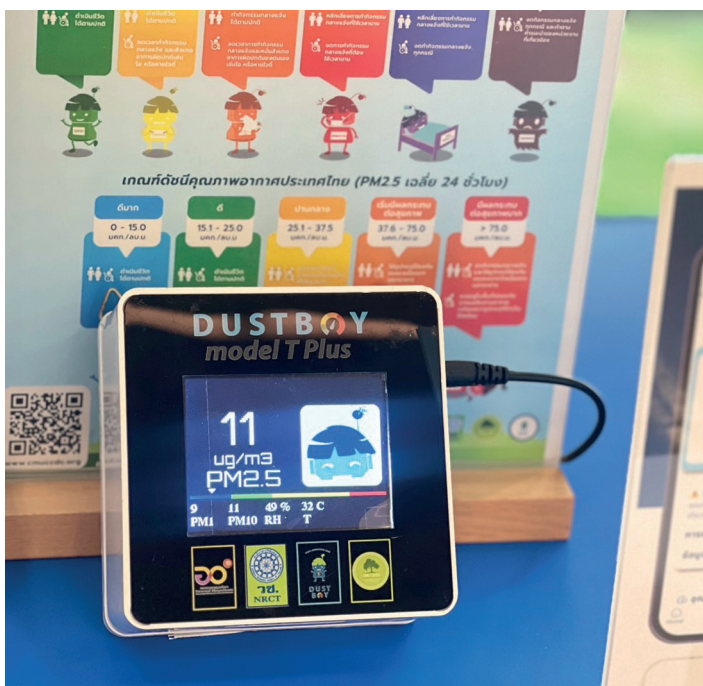
เครื่องตรวจวัดปริมาณฝุ่นละอองขนาดเล็กในบรรยากาศด้วยระบบเซนเซอร์ (DustBoy)
